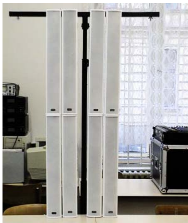
Obr.214 Laboratorní verze velké reproduktorové stěny 4 \times 16 ( 8 \times DPT208)
