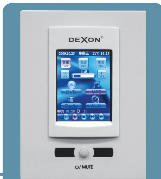
Poté, co jsme vyřešili ozvučovací síť, je vhodné se ještě zamyslet nad ovládáním a regulací hlasitosti. V případě klasického řešení s vlastním receiverem máme regulaci hlasitosti přímo receiveru. Účelné ale také je, abychom mohli regulovat hlasitost v jednotlivých místnostech. K tomu poslouží regulátor Dexon PR 300S ve stereo režimu. V případě
